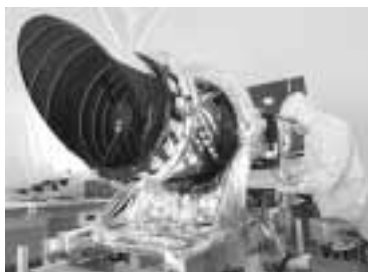
Die hochauflösende Kamera an Bord der MRO kann Objekte von der Größe eines Küchentisches erfassen.
