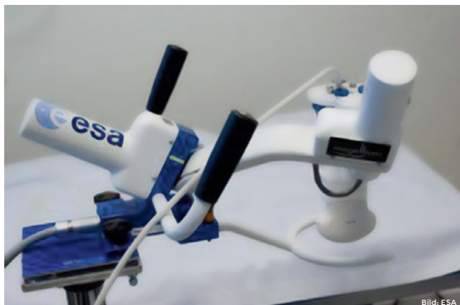
Abb. 2: Mit Mitteln der ESA entwickeltes ferngesteuertes Ultraschallgerät
