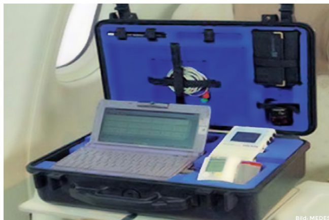
Abb. 3: Mobiles Gerät zur EKG- und Blutdruckmessung, dessen Daten automatisch an das nächste Krankenhaus übertragen werden
