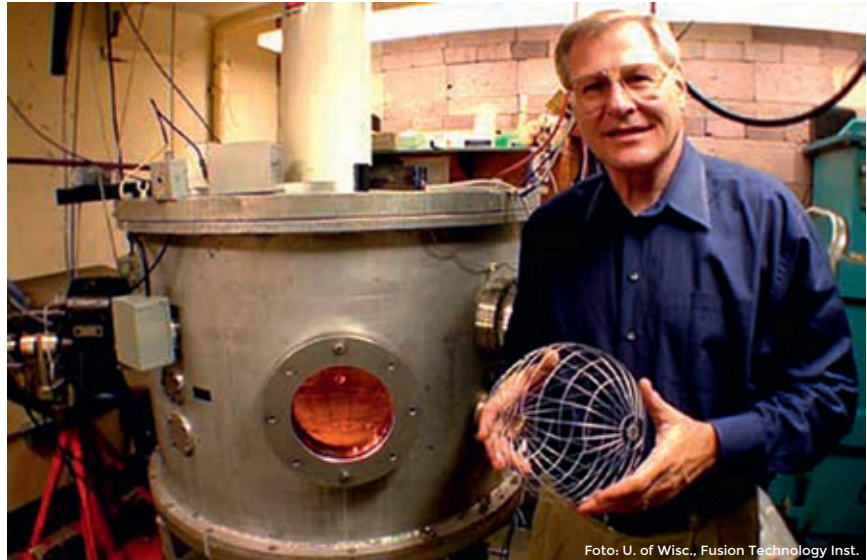
Prof. Gerald Kulcinski mit einer Anlage für den elektrostatischen Trägheitseinschluß. Foto: U. of Wisc., Fusion Technology Inst.
