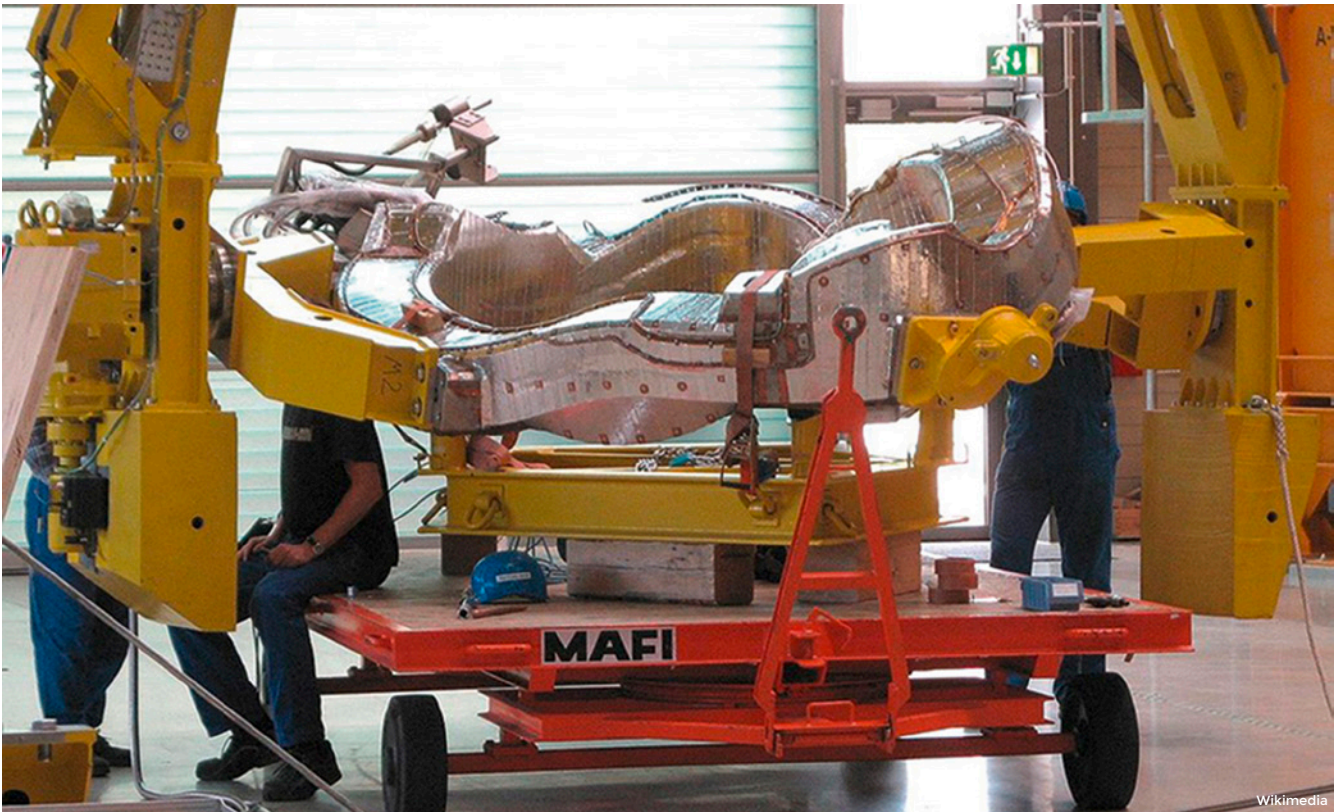
Eine der 50 supraleitenden nichtplanaren Magnetspulen des Stellarators in Greifswald vor der Montage. Ihr Durchmesser etwa 3,5 m, ihr Gewicht etwa 6 t.
