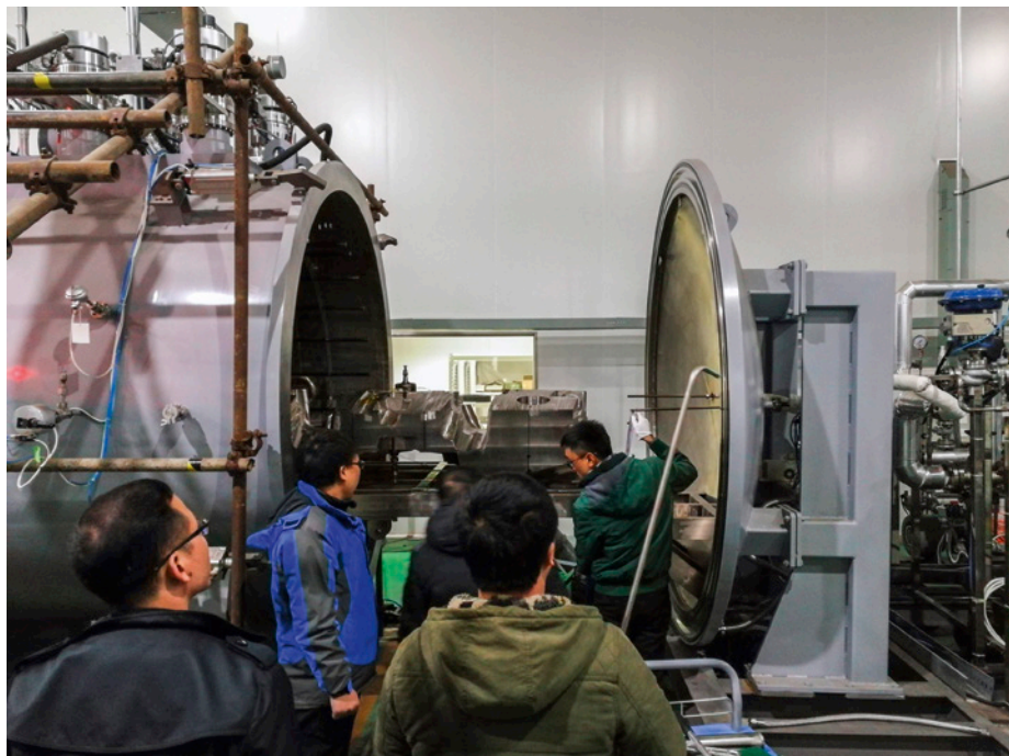
Ein vollständiger Prototyp eines in China hergestellten Mantelabschirmblocks (blanket shield block) hat im Februar 2018 erfolgreich alle Abnahmeprüfungen durchlaufen, vor allem die wichtige Dichtigkeitsprüfung für heißes Helium. China wird 50 Prozent der für ITER benötigten Mantelabschirmblöcke liefern (220 Einheiten).
