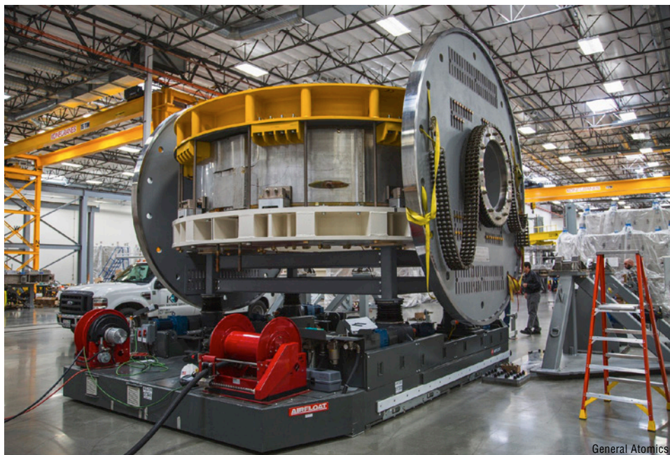
Die zentrale Magnetspule ist Teil des amerikanischen Beitrags für den ITER. Die weitere Finanzierung hierfür ist jedoch keineswegs gesichert.
