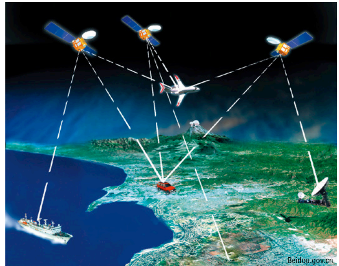
Illustration der Funktion des chinesischen Beidou-Navigationssystems.
